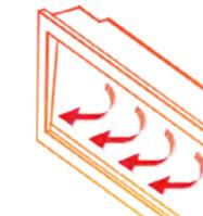
**Effetto Coanda:** molti modelli consentono di beneficiare di un confortevole effetto radiante frontale. Il vetro inclinato si riscalda grazie al flusso d'aria calda in discesa, generando calore radiante naturale.
