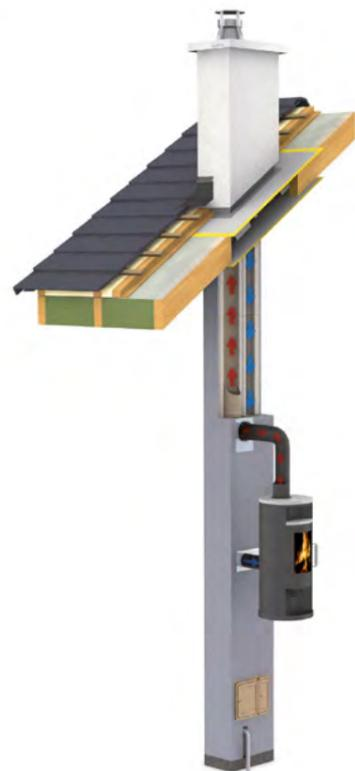
I modelli omologati DIBt possono essere installati con un modulo specifico per case passive e caseclima che consiste in un blocco prefabbricato in ceramico refrattario e calcestruzzo alleggerito e pre-isolato, che ingloba il condotto fumi e il condotto di adduzione dell'aria comburente.
